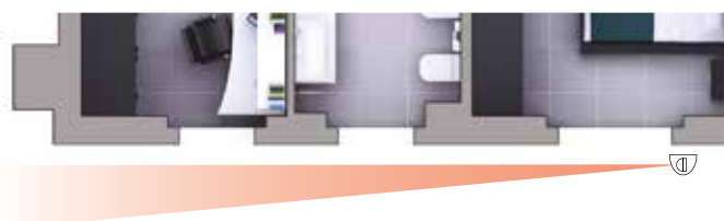
Protezione a tenda di una parete (rotazione di 90°)
